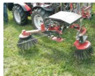
Soins mécaniques des lignes d'arbres (de gauche à droite): bineuse «Ladurner», bineuse à étoiles, bineuse rotative à fils de nylon, brosse de binage.
