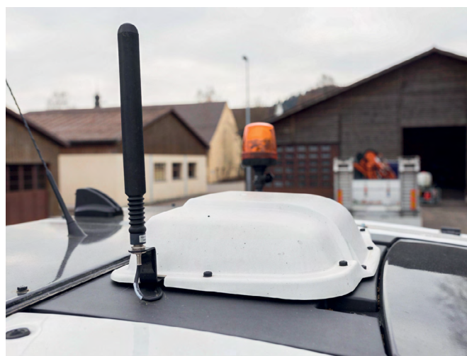
Figure 4. En utilisant un récepteur GNSS placé sur le toit du tracteur et un signal de correction RTK (RTK = Real-Time-Kinematik), il est possible de déterminer la position du véhicule avec une précision de \pm 2 cm). Les signaux de position sont automatiquement convertis en mouvements de direction par l'intermédiaire d'une soupape de commande.
