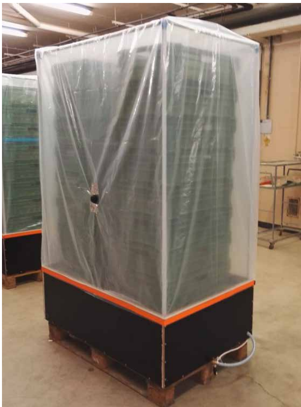
Figure 1 | Unité expérimentale automatisée fabriquée par Agroscope et permettant de traiter les pommes de terre de manière indépendante dans une même chambre froide. (Photo: Margot Visse-Mansiaux, Agroscope)
