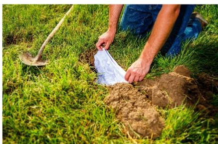
Abb. 1: Für den Test wird eine Baumwollunterhose eingegraben.
