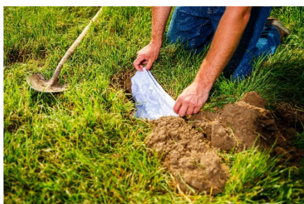
Fig. 1: Une culotte de coton est enfouie pour les besoins du test.
