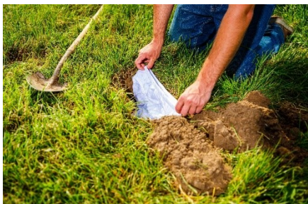
Foto 1: per il test viene sotterrato uno slip di cotone.
