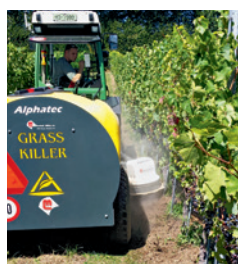
Dell'acqua viene spruzzata sulle piante attraverso piccoli ugelli e ad alta pressione, per distruggerle e successivamente mescolarle con la terra.
