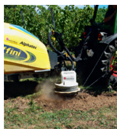
Dell'acqua viene spruzzata sulle piante attraverso piccoli ugelli e ad alta pressione, per distruggerle e successivamente mescolarle con la terra.
