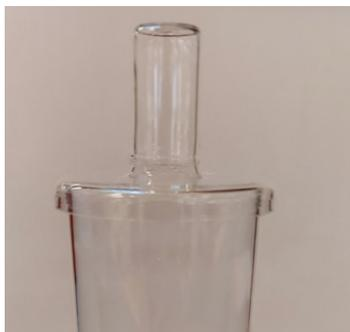
Abbildung 1: Beispiel für Deckel auf Extraktionsgefäss
