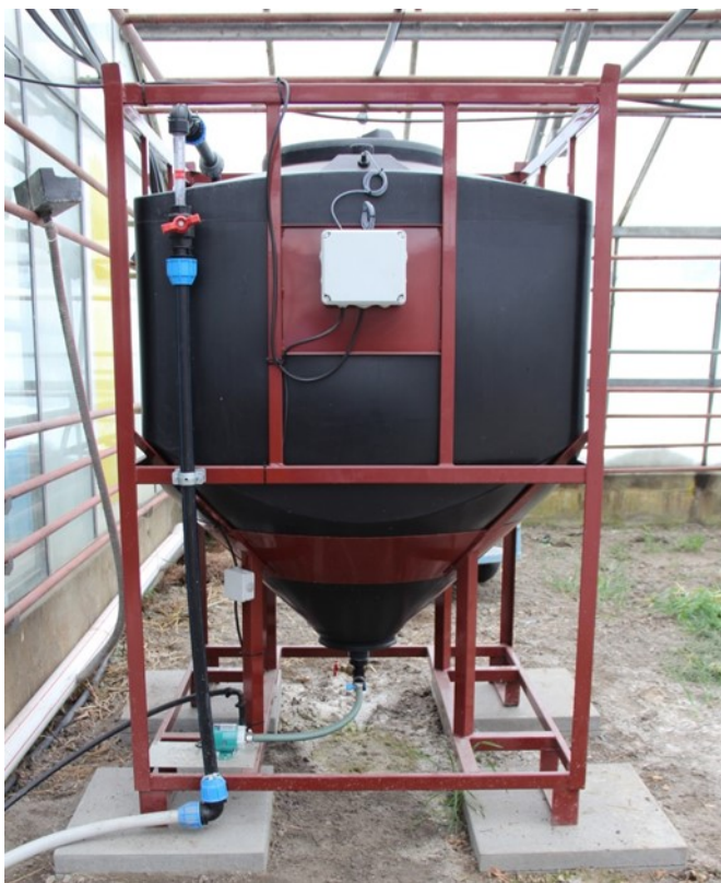
Foto 6. filtro a sabbia per la filtrazione lenta (foto: V. Günther)
