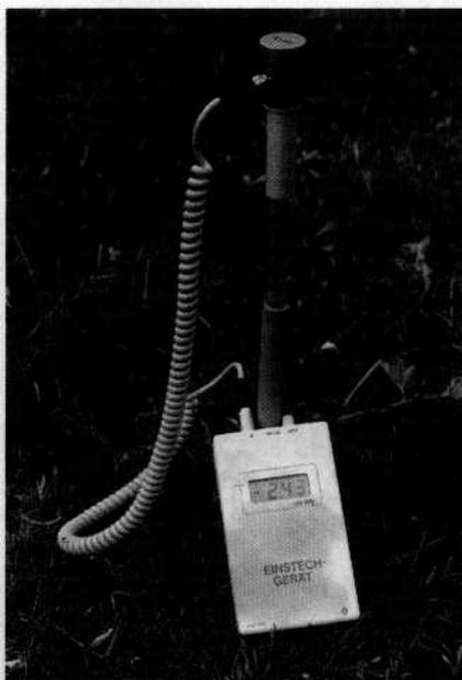
Fig. 1. Tensiomètre placé dans l'essai avec le capteur de pression planté dans son bouchon de tête et relié au dispositif de mesure.
