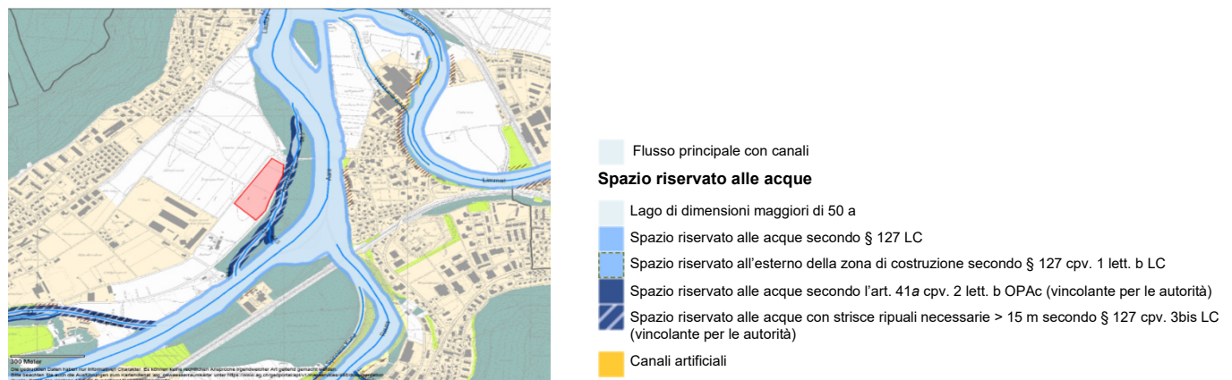
Fig. 1: Esempio di carta dal geoportale del Canton Argovia per lo spazio riservato alle acque vincolante per le autorità, ossia non ancora stabilito in modo definitivo e pertanto non ancora vincolante per i proprietari.
