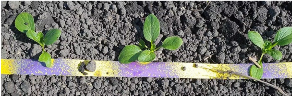
Abbildung 19: Überprüfung der Qualität der Behandlung von Pak-Choi mit wassersensitivem Papier. Der Durchmesser der Pflanze wird mit der Länge der Behandlung pro Pflanze verglichen, um die Genauigkeit der behandelten Flächen zu bestimmen.
