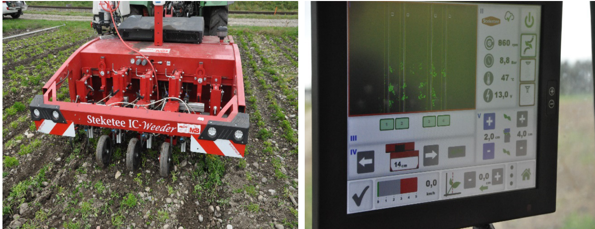
Abbildung 13: Testfahrt des PS-Roboters in gepflanzter, bereits mehrmals geschnittener Petersilie (links). Rechts: Darstellung der von der Kamera «erkannten» Pflanzen (links oben auf dem Display).
