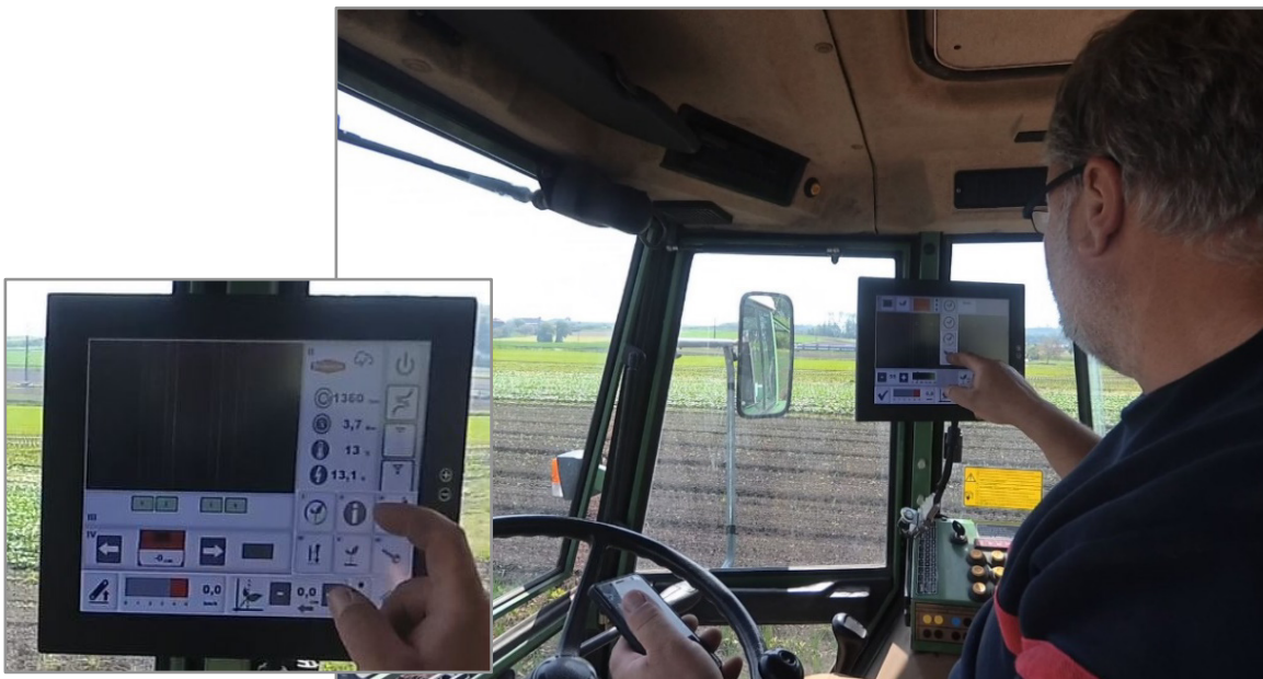
Abbildung 24: Das Display enthält neben dem Fenster für die Überwachung der Bildanalyse (hier schwarzer Bereich, vgl. Abb. 13) zahlreiche Bedienfunktionen, die mit Piktogrammen bezeichnet sind.
