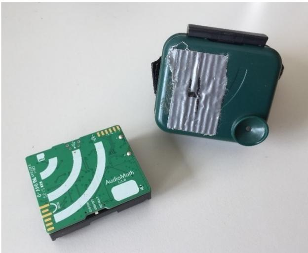
Figure 8: Un enregistreur AudioMoth avec son boîtier.
