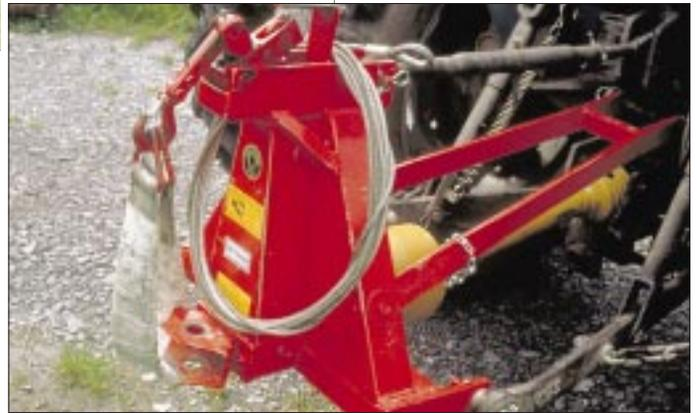
Abb. 3: Maschinelle Ernte mit dem Seilschüttler. (Foto: Albert Widmer, FAW)
