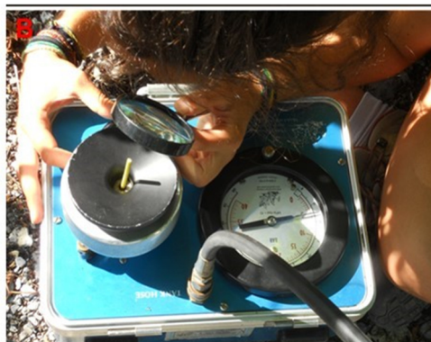
Figure 4 : La chambre à pression de Scholander permet de déterminer l'état hydrique de la plante
