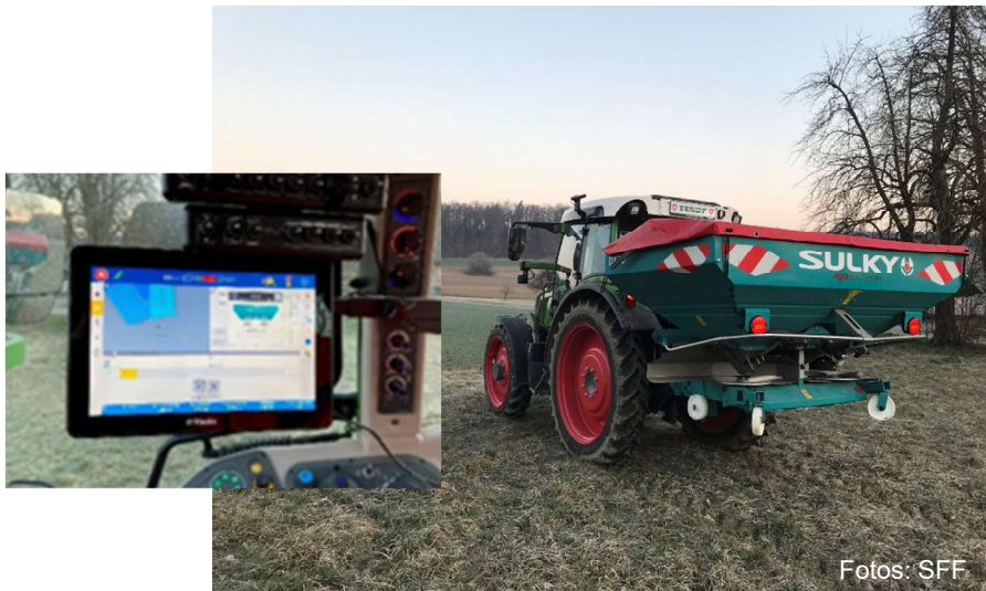
Duengerstreuer mit automatischer Mengenregelung auf Basis einer Applikationskarte
