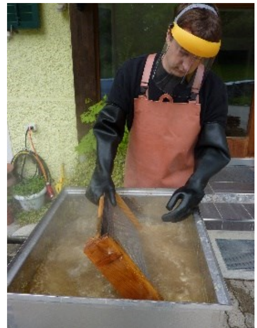
Fig. 8 : La soude caustique est plus dangereuse que la soude. Lors de la manipulation de ces deux substances, il faut porter des habits de protection (photo : T. Amsler)
