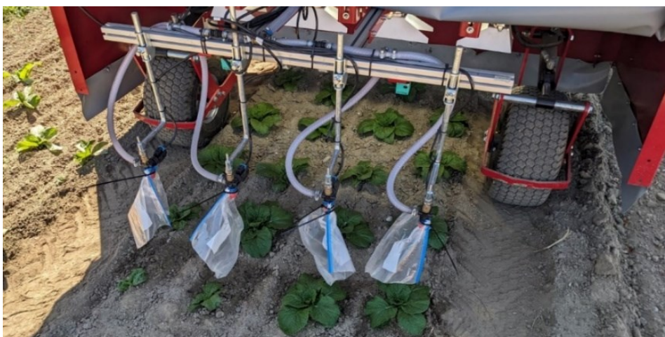
Abbildung 6: Sammeln von Wasser, das während einer Spotspraying-Überfahrt direkt aus den Düsen gespritzt wird. (Agroscope)
