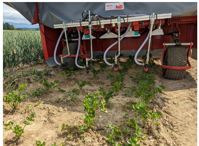
Abbildung 2: Links: Seiten- und Rückansicht des Prototyps II. Dieser ist traktorgezogen. Rechts: Mit hochgeklappter Haube, während der Behandlung ist diese geschlossen. (Agroscope)
