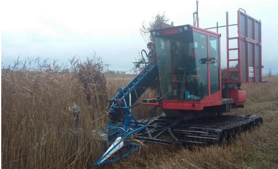
Abbildung 2: Schilfmahd mit raupenbasierter Technik. Foto: F. Birr
