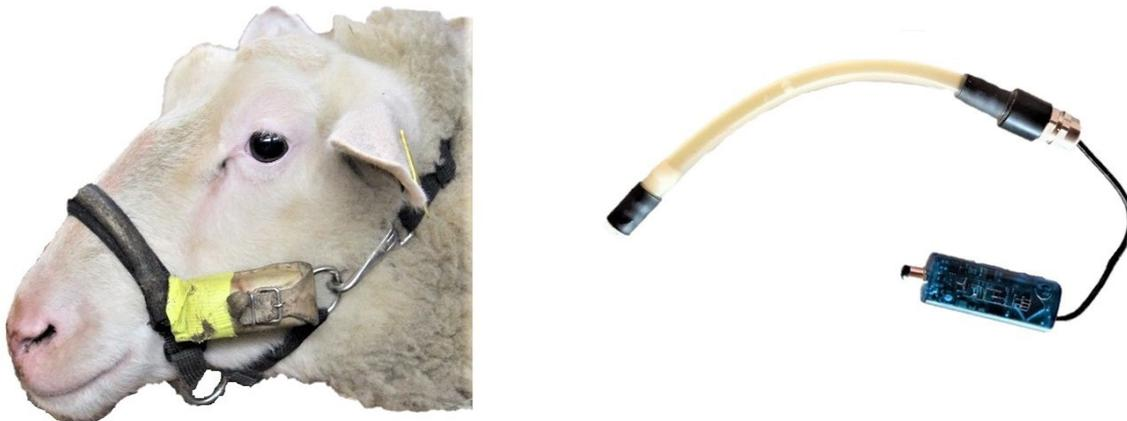
Abbildung 3 a, b: Milchschaaf mit Halfter zur automatisierten Erfassung des Fressverhaltens. Im Nasenband befindet sich ein ölgefüllter Schlauch, dessen Druckveränderungen durch die Maulbewegungen vom Sensor erfasst werden.
