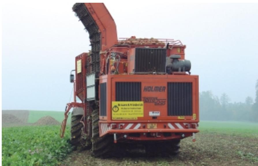
Fig. 1. Grâce au décalage du châssis (marche en crabe) et à sa plus grande largeur de récolte, l'automotrice à six rangs permet de réduire la surface de passage par rapport à la récolteuse tractée à deux rangs (135% au lieu de 298%). Le poids total de plus de 35 tonnes est réparti régulièrement sur toutes les roues.
