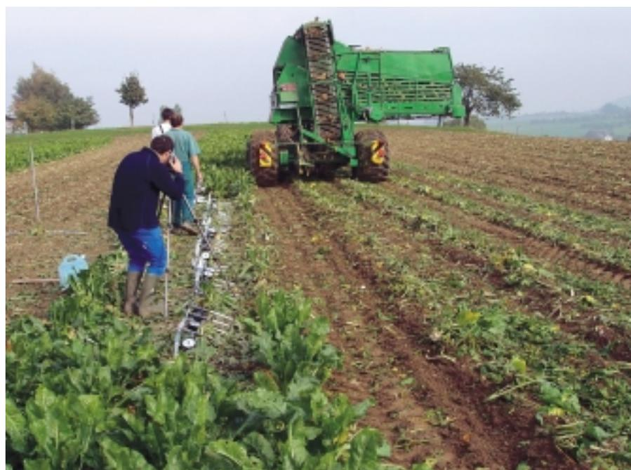
Fig. 2. Sondes Bolling peu après le passage de la récolteuse tractée à deux rangs. La moitié du poids total (12 tonnes) se trouve sur la roue située sous la trémie.
