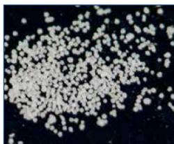
Aus Rinde isolierte Kristalle, mittels Röntgenbeugung als Ca-Hydroxyphosphat identifiziert
