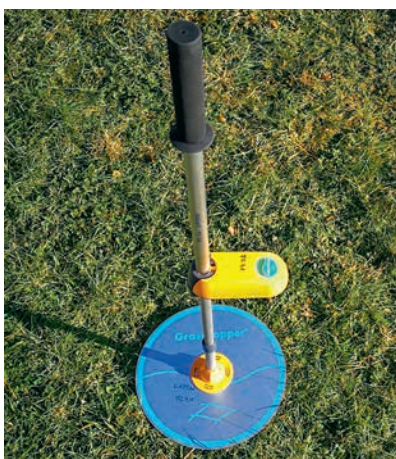
Der Sensor misst die Aufwuchshöhe und berechnet den Ertrag.
