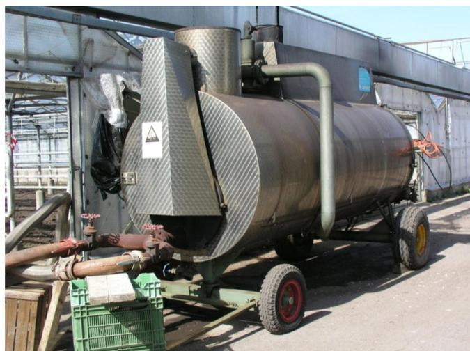
Figure 1: À gauche: préparation d'une serre pour une désinfection à la vapeur sous bâche (branchement visible au bas de la photo); à droite: chaudière à vapeur sur une exploitation agricole (photos: Reinhard Eder, Agroscope).
