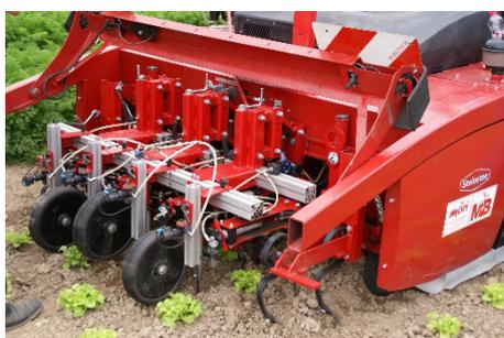
Foto 1: Im Rahmen des Projektes «Ressourcenschonender, nachhaltiger Pflanzenschutz im Gemüsebau durch kamera-gesteuerte Pflanzenschutzroboter» wurde ein Steketee-Hackgerät mit der Spot Spraying Technik kombiniert (Foto: Agroscope).
