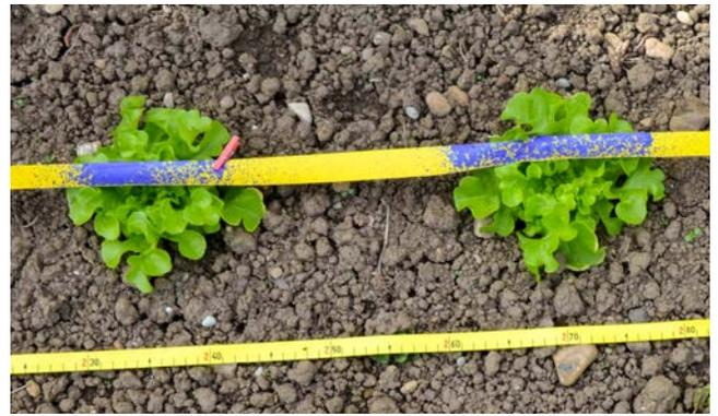
Wassersensitives Papier zeigt die behandelten Flächen beim Spot-Spraying.
