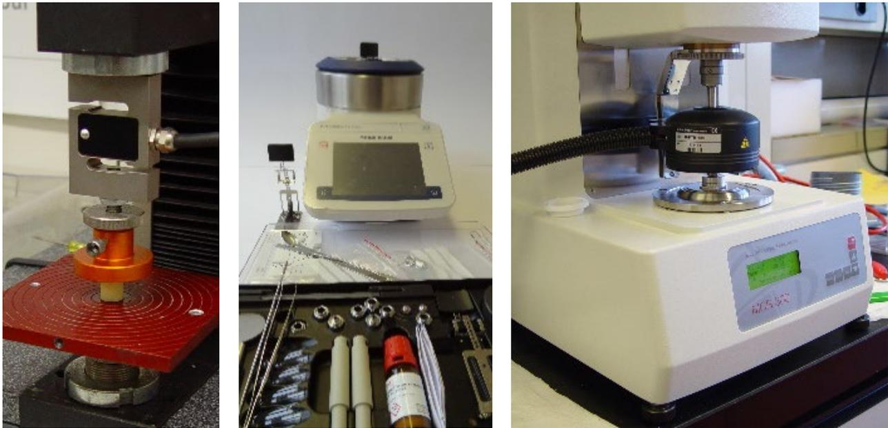
**Abbildung 3:** Analysengeräte zur Erfassung der physikalischen Eigenschaften von Walliser Raclette: Uniaxialer Kompressionstest mit der Universalprüfmaschine von Zwick (links), Messung des Erweichungspunktes mit dem Mettler-Toledo Gerät DP70 (Mitte) und Messung der Schmelzeigenschaften mit dem MCR300 Rheometer (rechts).
