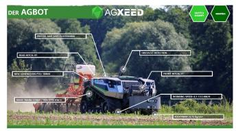
Abb. 2: AgBot – autonome Zugmaschine von AgXeed (Abbildung zur Verfügung gestellt von AgXeed).
