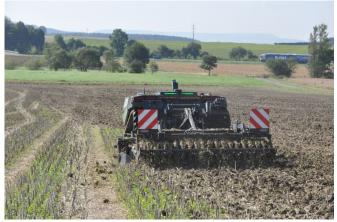
Abb. 4 Der AgBot wurde für die Stoppelbearbeitung so programmiert, dass er leicht diagonal zu den bestehenden Fahrspuren arbeitet. Dadurch werden die Arbeitsqualität der Scheibenegge verbessert und bestehende Spuren nicht mehrmals befahren (Foto: Agroscope).
