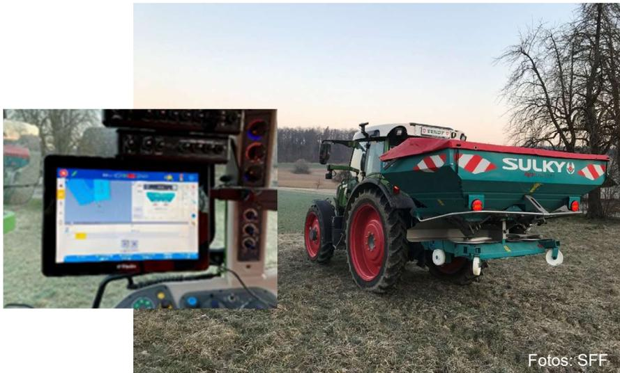
Düngerstreuer mit automatischer Mengenregelung auf Basis einer Applikationskarte
