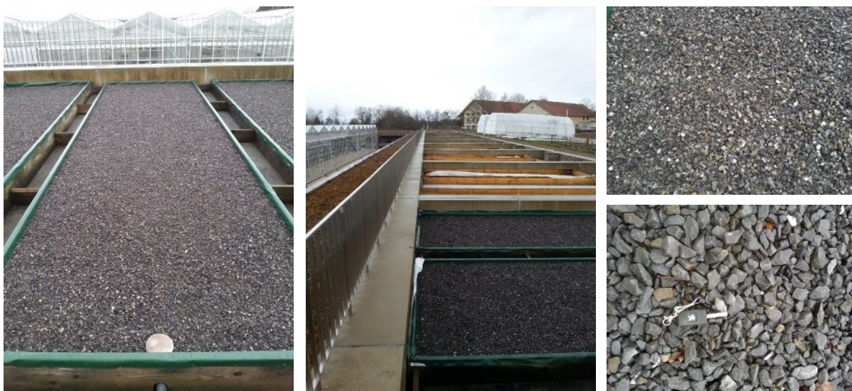
Abbildung 10: Dachanlage in Lullier (Januar 2020). Links: fertiggestellter Plot vor der Ansaat. Mitte: Abfolge verschiedener Versuche. Rechts oben: Auflagematerial. Rechts unten: Auflagematerial, vergrößerte Darstellung
