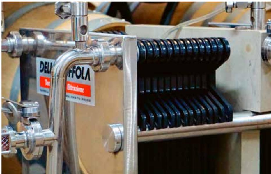
Abb. 7: Moderner Schichtenfilter mit 40cm-Platten. (© O+W)
