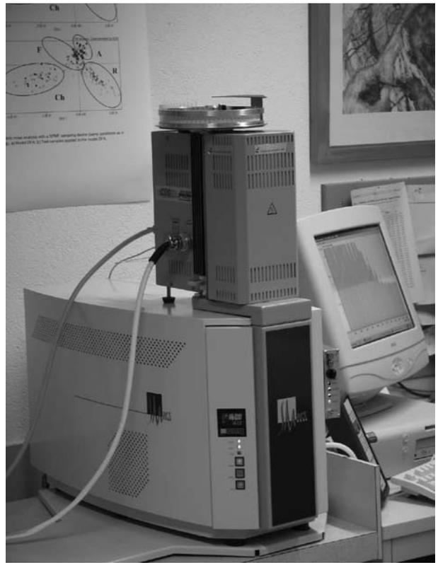
Abb. 1: Die E-Nase (SMart Nose®) besteht aus dem Massenspektrometer (unten), das mit einer automatischen Pyrolyseanlage (oben) gekoppelt ist.
