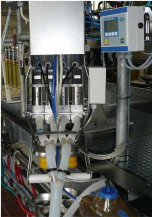
Abbildung 2: Versuchsaufbau mit den vier Vakuumdrosselventilen (VDV), welche in den vier viertelindividuell geführten Milchschräuchen eingebaut sind.
