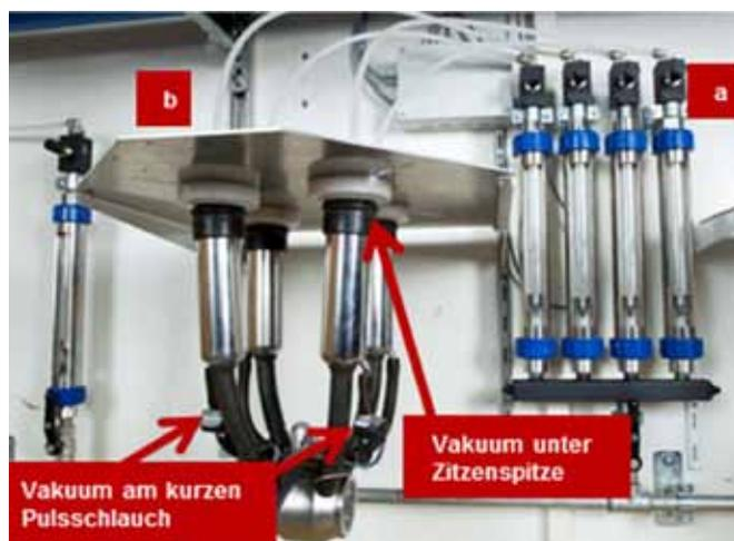
Abbildung 1: Milchflusssimulator (b) an Melkplatz 2 mit vier Durchflussmessern (a) und den Drucksensoren «Vzspi» (Vakuum unter der Zitzenspitze) und «Vpuls» (Vakuum am kurzen Pulsschlauch).
