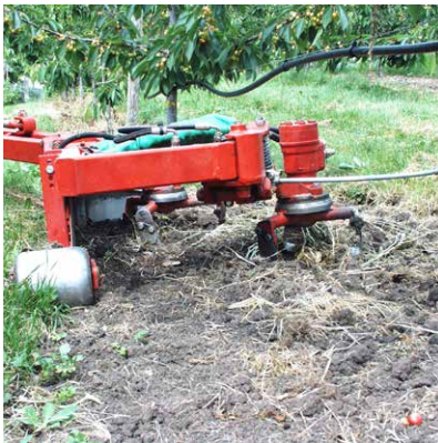
Abbildung 1: Mit dem Ladurner wird der Boden geöffnet und so der Stickstoff mobilisiert.
