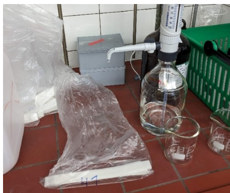
Abbildung 18: Tracer-Extraktion der Driftprobe mit Isopropanol (Quelle: Agroscope).
