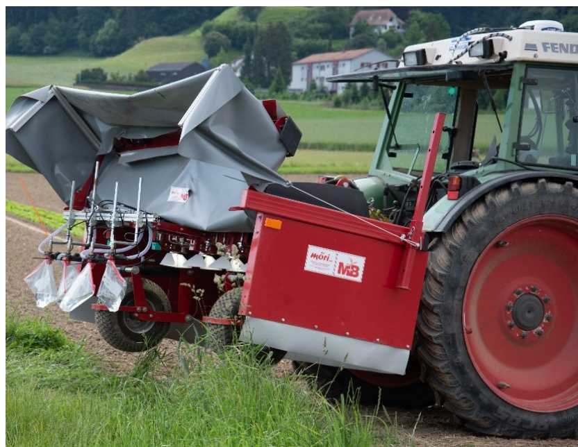
Abbildung 5: Auffangen des während einer Spotspraying-Überfahrt aus den Düsen ausgebrachten Wassers. (Quelle: Agroscope)
