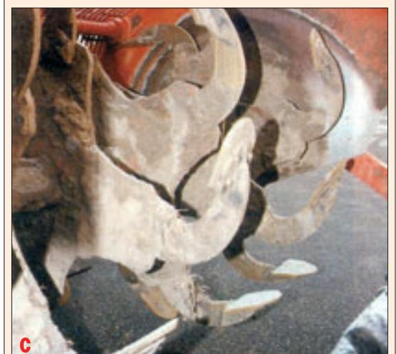
Abb. 1 a–c: Spatenmaschinen: a mit Einzelspaten, b mit Doppelspaten, c Rotationsspatenmaschine.
