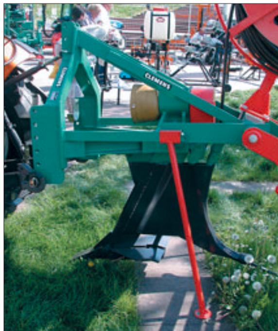
Abb. 5: Ein Wippschar-Lockerer, der im gleichen Arbeitsgang Bewässerungsschläuche verlegen kann.
