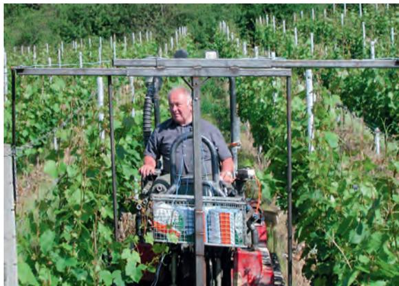
Abb. 5: Einfacher Laubhefter – Eigenkonstruktion.
