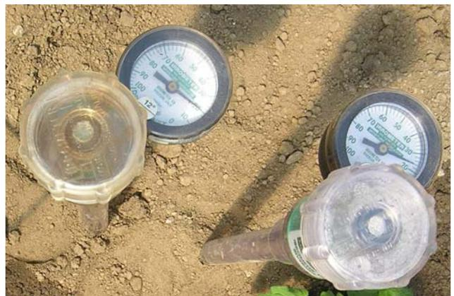
Abb. 6: Tensiometer erlauben es den Zustand der Bodenfeuchtigkeit zu kennen und entsprechend zu bewässern.
