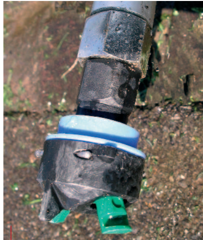
Twin-Spray-Cap mit zwei Deflector-Flachstrahldüsen montiert am unteren bodennahen Ende des Droplegs.
