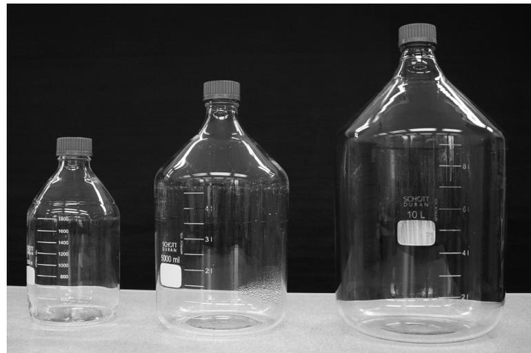
Abb. 4 Einsatz von 2, 5 oder 10 Liter Glasflaschen (SCHOTT DURAN) und Chromstahlbehältern 15 Liter in der Kulturenproduktion
