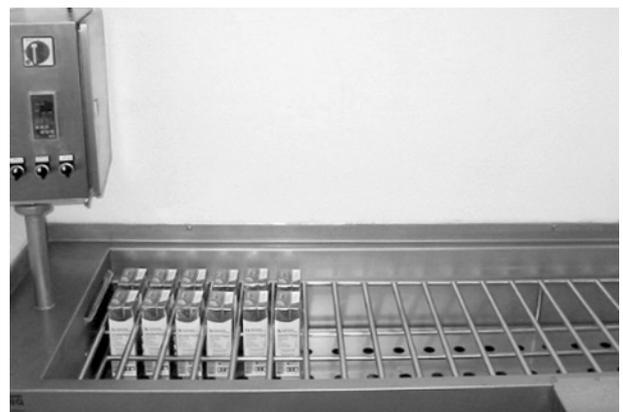
Beim Einsatz von grösseren Gebinden ist unbedingt zu beachten, dass sich der Zeitbedarf für das Erhitzen auf Sterilisationstemperatur und die spätere Abkühlung deutlich verlängert, da die Wärmeaustauschfläche im Verhältnis zum Volumen abnimmt (Abb. 5).
