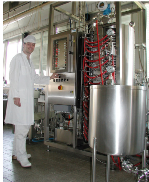
Abb. 1: Thermische Vorbehandlung mit ALP-Pilotanlage (flexibles Röhrentauschersystem; Leistung 100 l/h)
