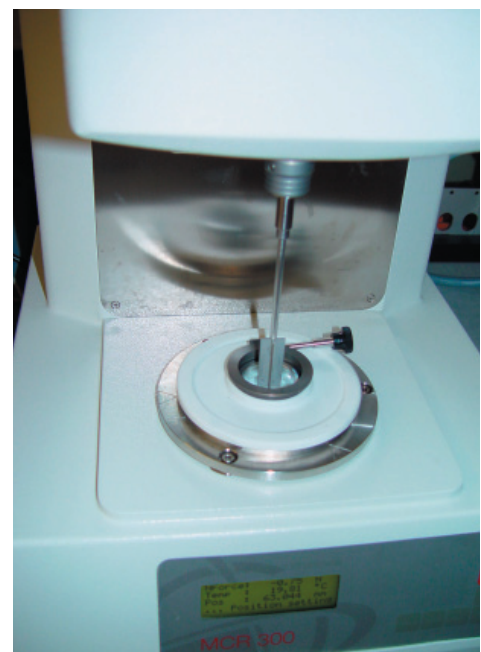
Abbildung 13: Rotationsrheometer mit Flügelrührereinsatz für zerstörungsfreie Oszillationsmessungen
