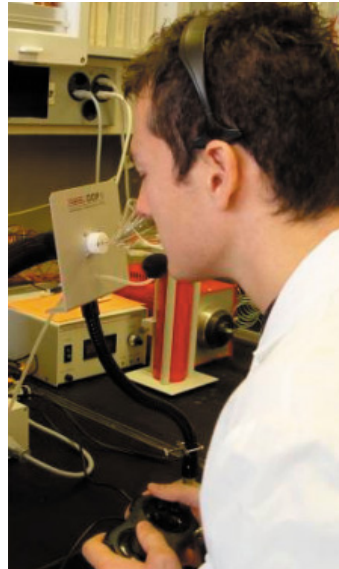
Abb. 4: Gaschromatographie-Olfaktometrie an einem sogenannten «Sniffing-Port»
