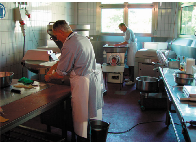
Abb 2: Herstellung der Salami mit Wolf (Mitte, hinten), Mischer (rechts, Mitte) und Füllmaschine (links, vorne)
