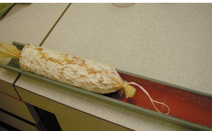
Abb. 6: Messung der Oberflächenschimmelhaftung über eine mit Sandpapier ausgelegte Halbröhre (nach P. Hofmann, SV ALP)
