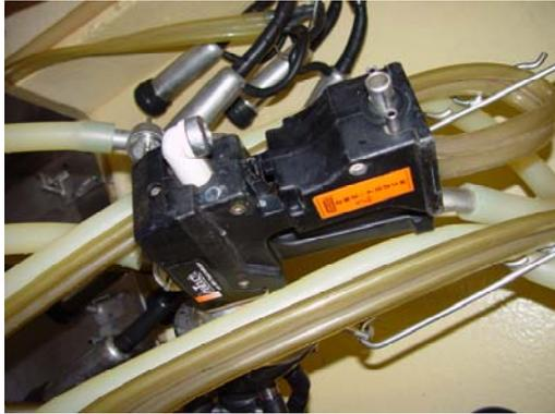
Die Melkzeuganschlüsse werden immer ausgeklügelter, sind aber leider nicht einfacher zu reinigen.
