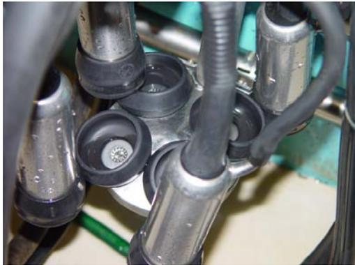
Die Melkzeugaufnahmen der Reinigungseinrichtung sind von Hand zu reinigen, besonders in den Melkständen. Die Melkzeuge müssen nach der Reinigung zum Trocknen aufgehängt werden.
