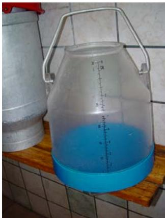
Solche Plastikbehälter, die nicht den Qualitätsanforderungen entsprechen, werden von einigen Melkanlagenhersteller geliefert. Sie dürfen nicht für abgelieferte Milch verwendet werden.
