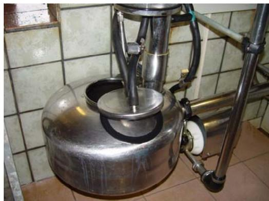
Beispiel einer Dichtung (Endeinheit), die bezüglich Sauberkeit zu überwachen und gegebenenfalls von Hand zu reinigen ist.
