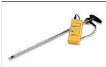
Abb. 2: Geeignete Messinstrumente erlauben es, den Feuchtegehalt in den Ballen direkt auf dem Feld zu bestimmen.
