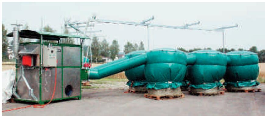
Abb. 4: Belüftungsanlage Tecnolam für Rundballen hat einen höheren Investitionsbedarf und beansprucht einen geringeren Energieaufwand.
