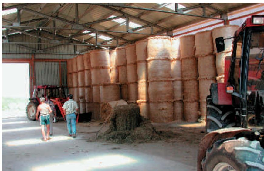
Abb. 5: Ballenlager erfordern einfache Gebäude, die für den Ballenumschlag mit Fahrzeugen befahrbar sind.
