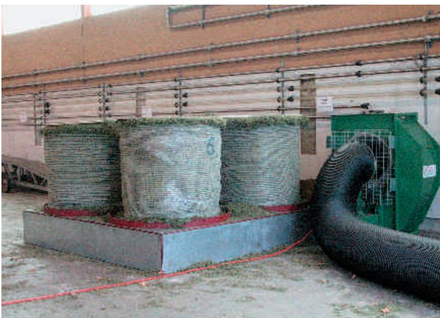
Abb. 3: Die Belüftungsanlage GEBA für Rundballen hat einen geringen Investitionsbedarf, beansprucht jedoch viel Energie.
