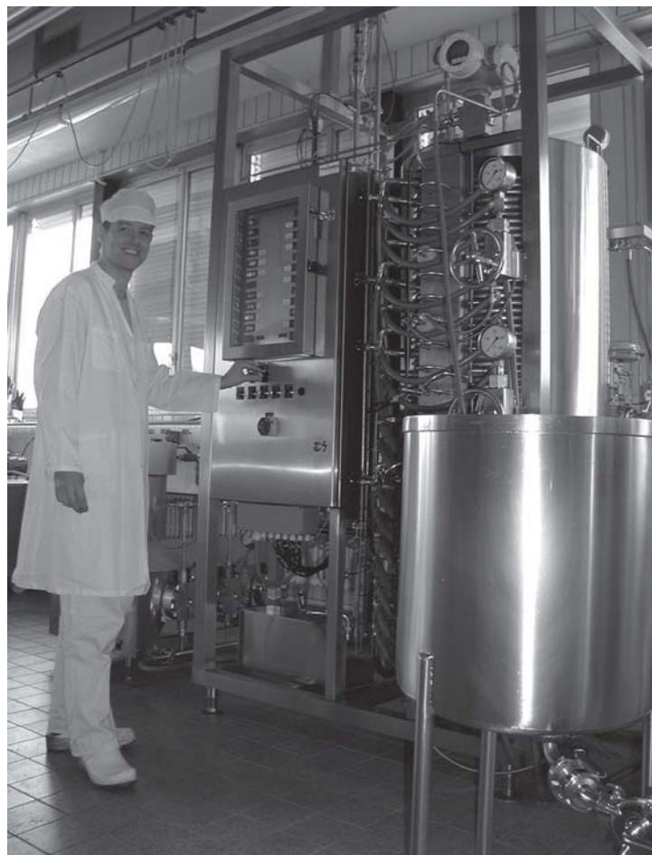
Abb. 1. Thermische Vorbehandlung mit ALP-Pilotanlage (flexibles Röhrentauschersystem; Leistung 100 l/h).
