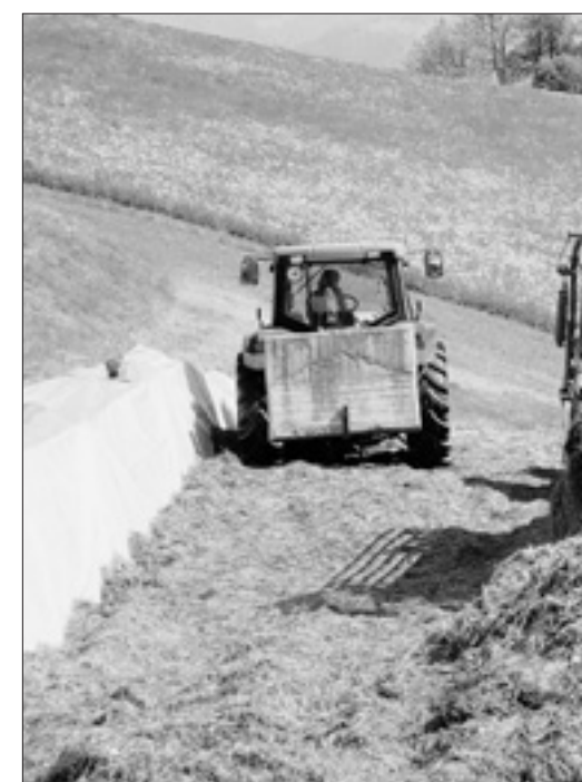
Beim Flachsilo ist ein sofortiges Walzen mitentscheidend für gute Qualität. (Bilder: Reto Elmer)
