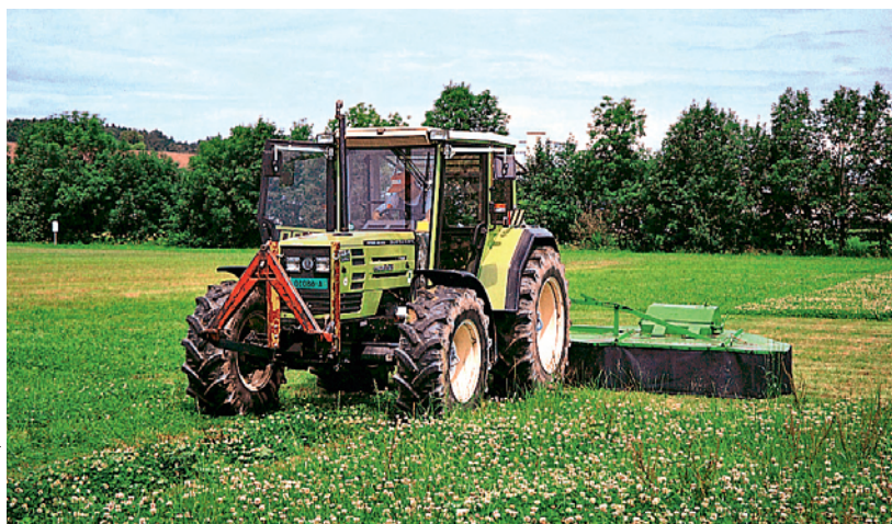
Mähmaschine mit Aufbereiter (Rotationsmähwerk und Schlegelmulchgerät) mäht blütenreiche Weissklee-Wiese.
