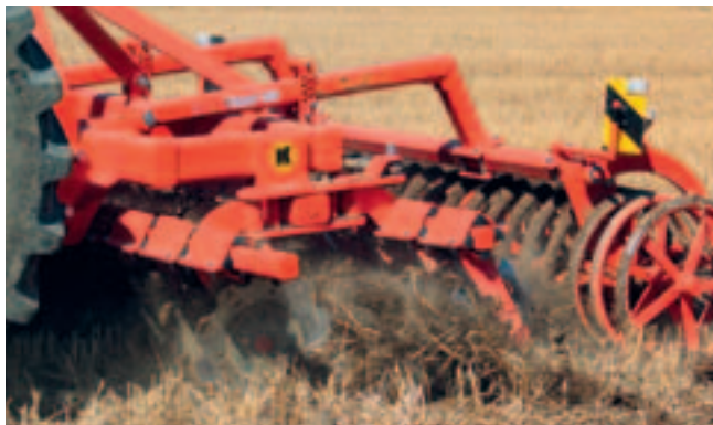
Fig. 10: Les herse à disques indépendants, conviennent parfaitement pour les cures anti-adventices. Lorsque la paille a été enlevée correctement après les céréales, le traditionnel vibroculteur (à droite) fait également du bon travail.
