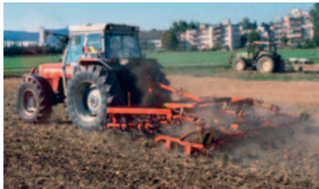
Fig. 10: Les herse à disques indépendants, conviennent parfaitement pour les cures anti-adventices. Lorsque la paille a été enlevée correctement après les céréales, le traditionnel vibroculteur (à droite) fait également du bon travail.
