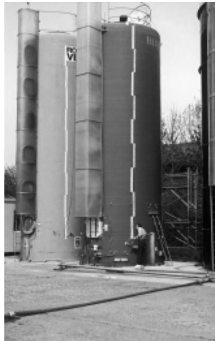
Abb. 8: Links geschleudertes Silo, rechts gewickeltes Silo. Die beiden Versuchssilos hatten folgende Abmessungen: h = 10 m, d = 3,5 m, V = 100 m 3 . Alter bei Versuchsbeginn: 7 Jahre.
