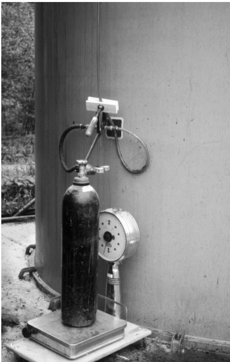
Abb. 11: Injektion von \text{CO}_2 -Gas in den voll mit nassem Grashäcksel gefüllten Silo. Bei keiner Messung konnte ein Gasdruck von über einem bar festgestellt werden.
